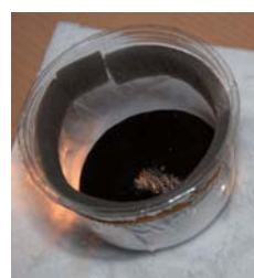
▼霜箱を組み立ててウランやトリウムが出すアルファ線を確認
