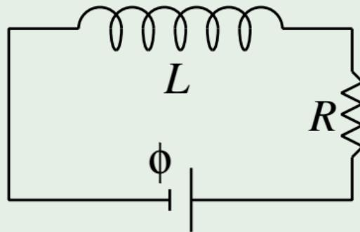
回路中の全起電力は式(12)より,  $\phi - L(dI/dt)$ . オームの法則より,
