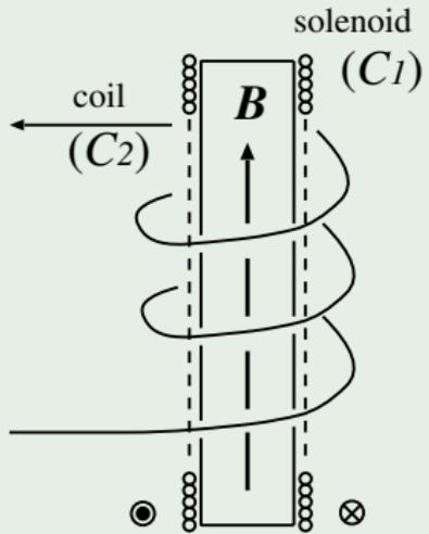
ソレノイド ( $C_1$ ) の断面積  $S$ , 卷数  $N_1$ , 長さ  $\ell$ , 電流  $I_1$  とし, コイル ( $C_2$ ) の巻き数を  $N_2$  とする.
