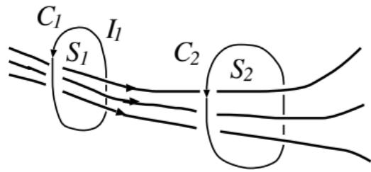
2つの回路  $C_1, C_2$  を考える。 $C_1$  に電流  $I_1$  を流すと磁束密度  $B_1$ (ベクトルポテンシャル  $A_1$ ) が生じる。このとき、 $C_2$  を貫く磁束  $\Phi_{21}$  は、 $I_1$  に比例する。
